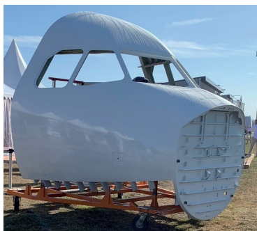
Section de fuselage avant A320 assemblée à Airbus Atlantic Méaulte
